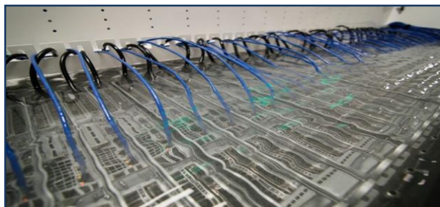
Slika 3.24 Serveri potopljeni u rashladnoj tečnosti [95]
