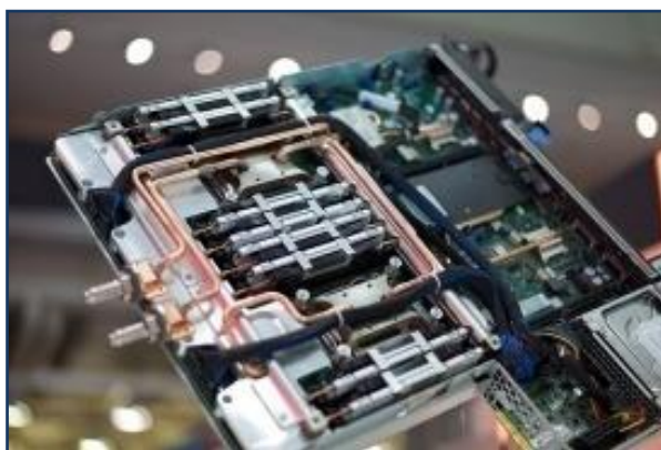
Slika 3.22 Prikaz direktnog vodenog hlađenja [88]
